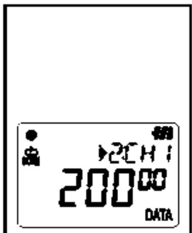
5. Отображение количества записанных данных на Канале 1/ количество данных **определенного** тока и напряжения (в Триггерном режиме записи).
