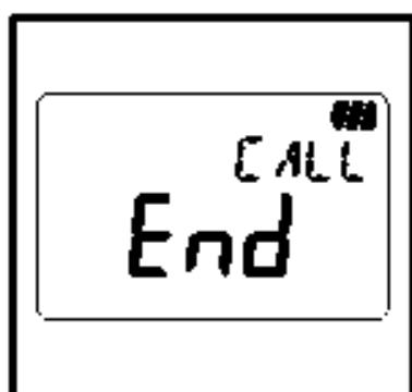
9. Это окончание работы функции «ПРОСМОТР» для проверки записанных данных. Нажатие кнопки позволяет перейти к функции «ПРОСМОТР»; нажатие кнопки позволяет перейти в режим Меню и подготовиться к проведению измерений.
