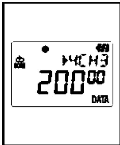
7. Отображение количества записанных данных на Канале 3/ количество данных **определенного** тока и напряжения (в Триггерном режиме записи).
