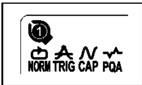
Проверьте символ, означающий выбранный режим записи. Для изменения режима записи данных или состояния записи данных (Интервал записи/ заданный ток), см. пункт «5. Режимы и состояния записи».
