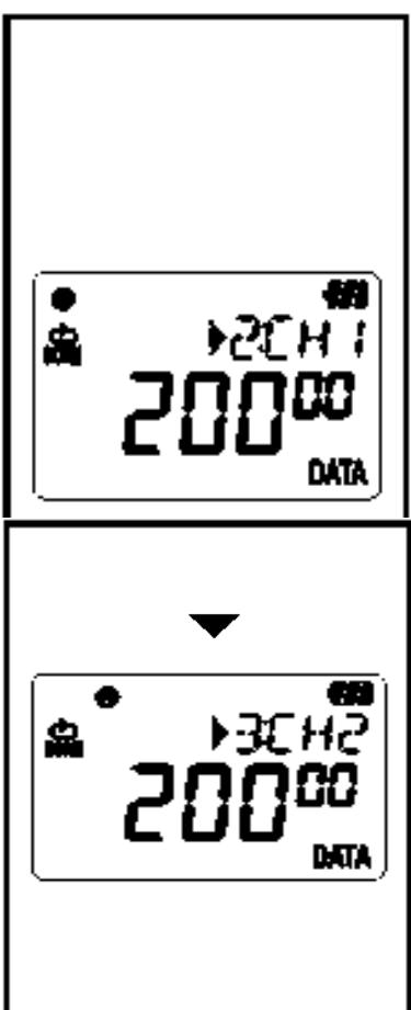
5. Отображение количества записанных данных на Канале 1/ количество данных определенного тока и напряжения (в Триггерном режиме записи).
