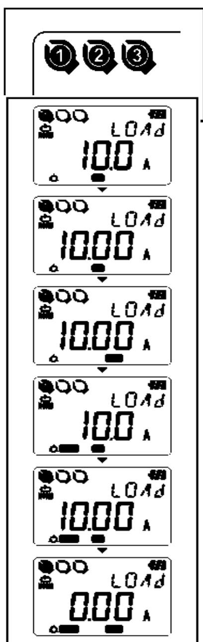
3) Для того, чтобы переключать на индикаторе отображение полученного значения в соответствии с нужным каналом (от CH1 до CH3), нажмите кнопку **CH**. Убедитесь, что Клещевые адаптеры подсоединенны к соответствующим каналам.
