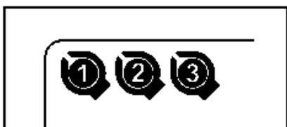
3) Для того, чтобы переключать на индикаторе отображение полученного значения в соответствии с нужным каналом (от CH1 до CH3), нажмите кнопку **CH**. Убедитесь, что Клещевые адаптеры подсоединены к соответствующим каналам.
