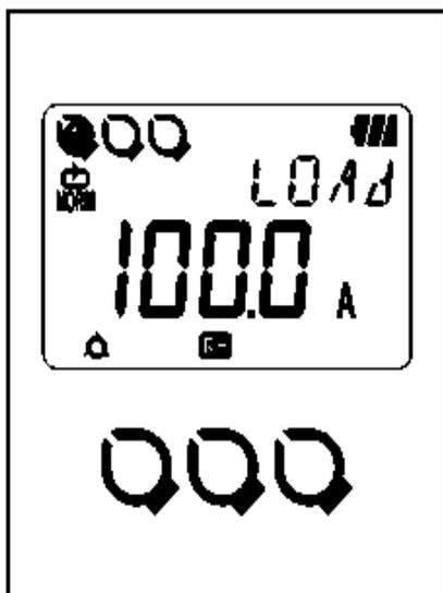
3. Проверьте подсоединенные клещевые адаптеры. На индикаторе отображаются символы подсоединенных клещевых адаптеров и полное значение шкалы (начиная с Канала 1).
