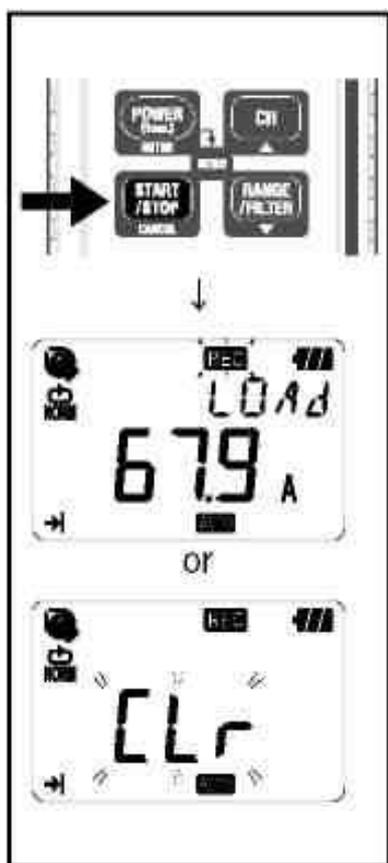
1) Нажмите и удерживайте кнопку **START/STOP** в течение 4 сек. На индикаторе замигают символ **REC** или надпись «Clr». Удерживайте кнопку в нажатом состоянии до тех пор, пока на индикаторе не загорится символ **REC**. **Запись продолжается до тех пор, пока кнопка нажата и пока на индикаторе мигает соответствующий символ.**
