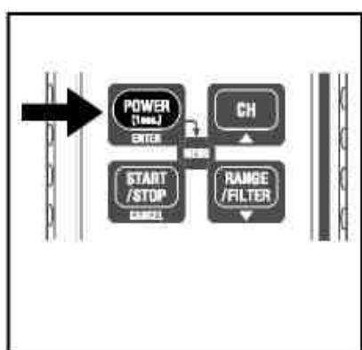
2. Для того, чтобы включить прибор снова нажмите «Power». Отпустите кнопку, когда на индикаторе отобразятся все символы. Сначала отображается время, а затем подсоединеные клещевые адаптеры. Если при включении прибора отображается неверное время, это может означать, что внутренняя часовая батарея разряжена. В таком случае следует вернуть прибор Вашему дилеру компании KYORITSU для его ремонта.
