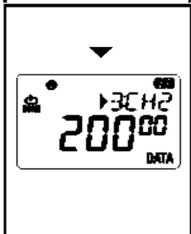
6. Отображение количества записанных данных на Канале 2/ количество данных **определенного** тока и напряжения (в Триггерном режиме записи).
