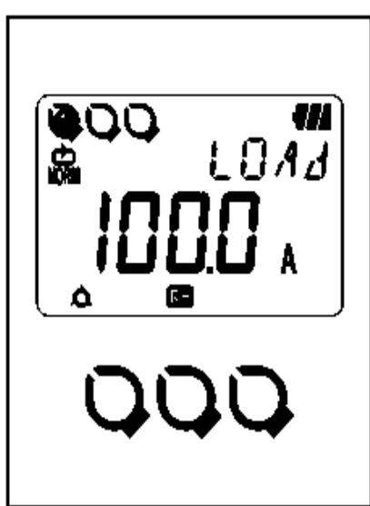
3. Проверьте подсоединеные клещевые адаптеры. На индикаторе отображаются символы подсоединеных клещевых адаптеров и полное значение шкалы (начиная с Канала 1).
